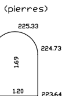
Entrée Tunnel Amont
